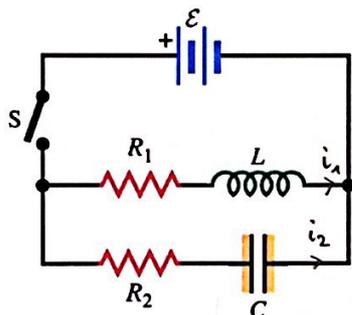
$$a) \quad \varepsilon = R_1 i_1 + L \frac{di_1}{dt} = R_2 i_2 + \frac{q_2}{C}$$
